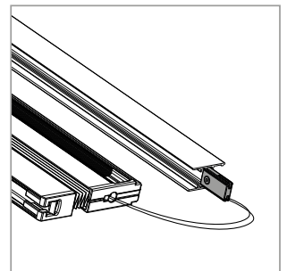
7 Introducir el tensa hilo en la parte superior del perfil confronto lateral.
