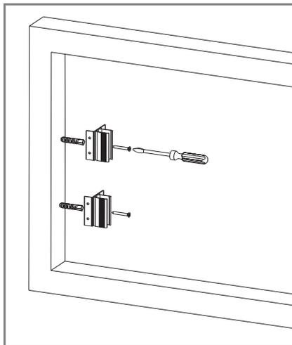
**2** Posizionare le clips fermoguida laterali sia a sinistra che a destra, facendo attenzione al verso di fissaggio.
